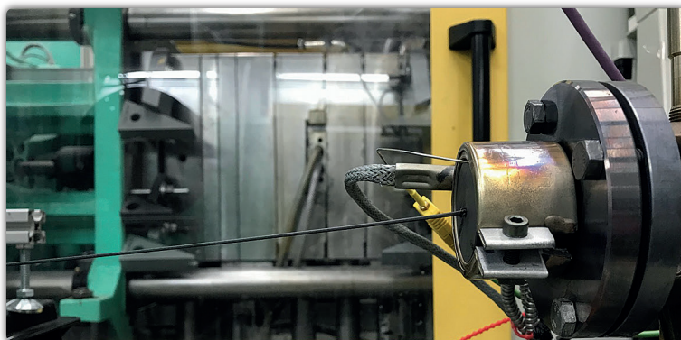
Bild 5. Temperaturverlust bei der Filamentherstellung von Hochtemperaturkunststoffen (ohne zusätzlichen Nachtemperierungsprozess). © Prigann /
